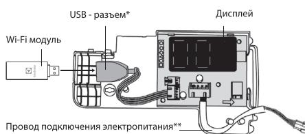
\* Разъем для подключения Wi-Fi модуля
