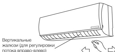
Направление воздушного потока в горизонтальной плоскости изменяется вручную поворотом вертикальных жалюзи.
