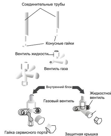
1. Отвинтите и снимите крышку из трехходового или четырехходового клапана.
