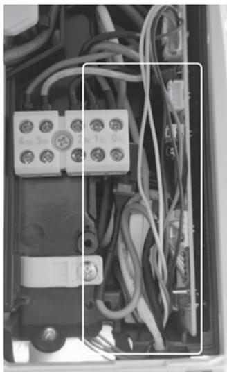
6. Закройте блок электроники крышкой, закрутите крепежный винт крышки блока электроники, закройте переднюю панель кондиционера и подключите кондиционер к сети электропитания. Можно переходить к настройке подключения кондиционера к сети Wi-Fi.
