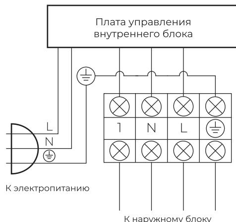
**Клеммный терминал наружного блока**
