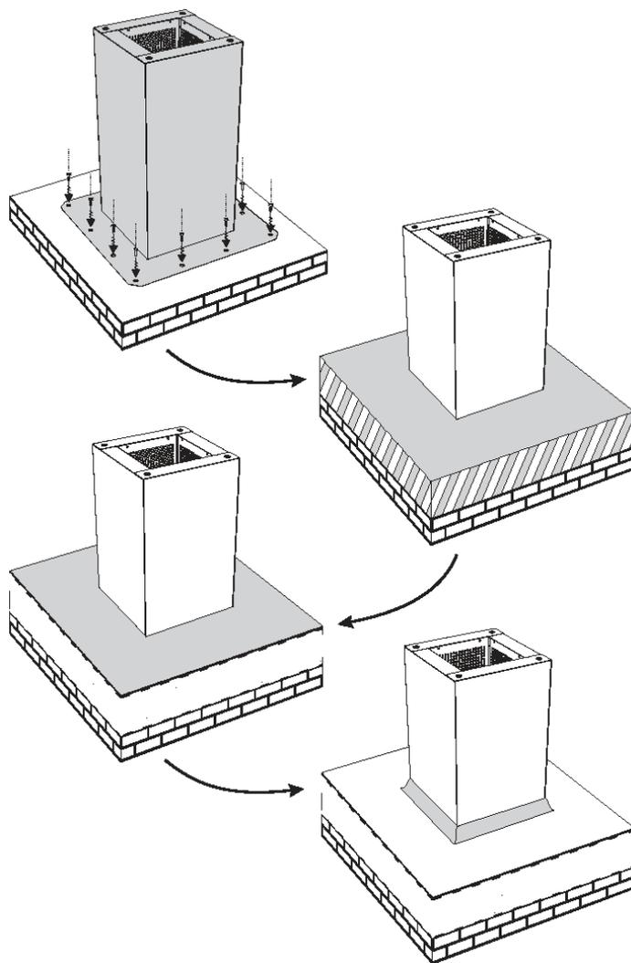
Крышный короб должен быть прочно прикреплен к крыше так, чтобы установленный вентилятор находился в горизонтальном положении.
