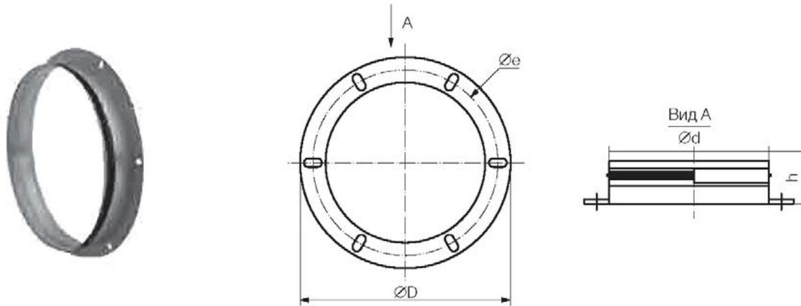
Фланцы FGV с резиновым уплотнителем для присоединения вентиляторов к воздуховодам. Изготовлены из оцинкованной стали.
