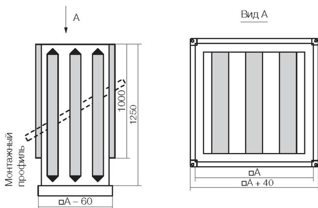
Крышные короба RRS из оцинкованной стали с шумоглушителями для монтажа на наклонной кровле. Для монтажа короб комплектуется согласно проектной документации монтажным профилем (не входит в комплект поставки).
