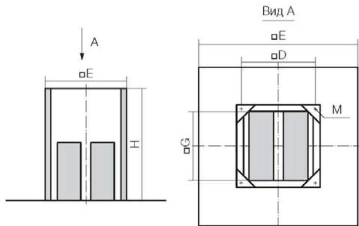
Крышные короба RCS из оцинкованной стали с шумоглушителями для монтажа на плоский кровле. Шумоглушающий материал обладает стойкостью к износу при скорости воздуха до 20 м/с.
