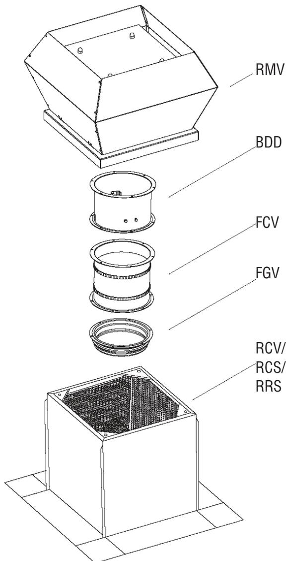
Оборудование монтируется на крышном коробе с использованием определенных аксессуаров: обратный клапан, гибкая вставка, соединительные фланцы. Их можно монтировать только таким образом, как показано на рисунке.
