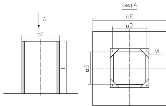
Крышные короба RCV из оцинкованной стали для монтажа на плоский кровле, толщина теплоизоляции 50 мм.
