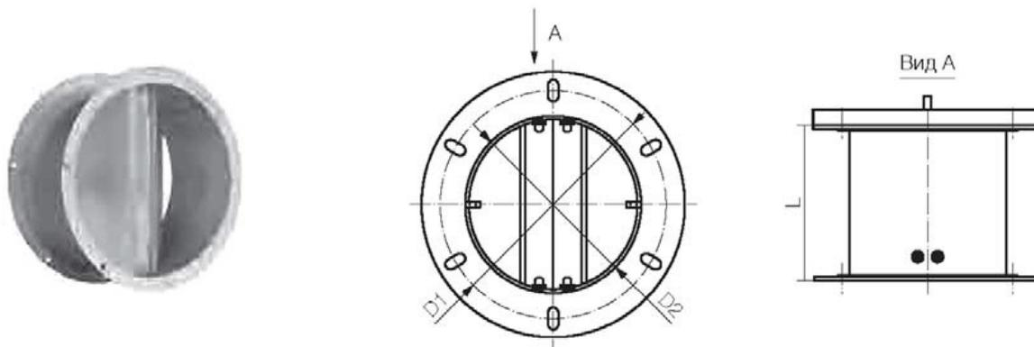
Обратные клапаны BDD из оцинкованной стали с алюминиевыми створками. Размеры и вес фланцев FGV, гибких вставок FCV и обратных клапанов BDD
