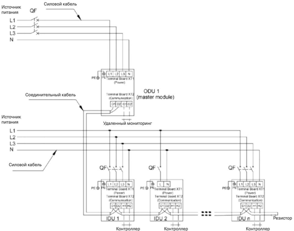
**Электрическая схема подключения для многомодульной комбинации**
