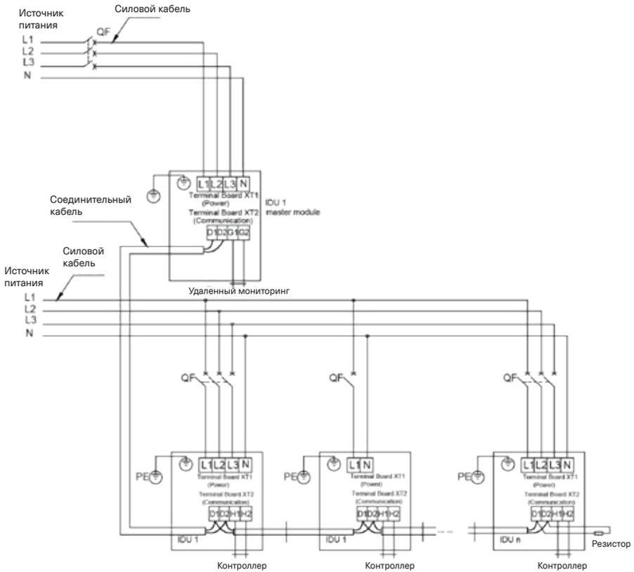
**Электрические подключения наружных блоков**
