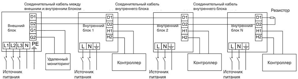
**Электрическая схема подключения для немодульных наружных блоков (SMZUi271V3AI, SMZUi311V3AI) can't operate normally.**
