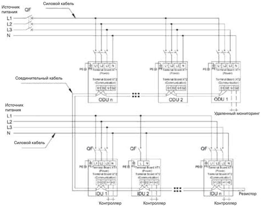
**Электрическая схема подключения для серии Slim (SMZUi75V2Ai, SMZUi96V2Ai, SMZUi120V2Ai)**
