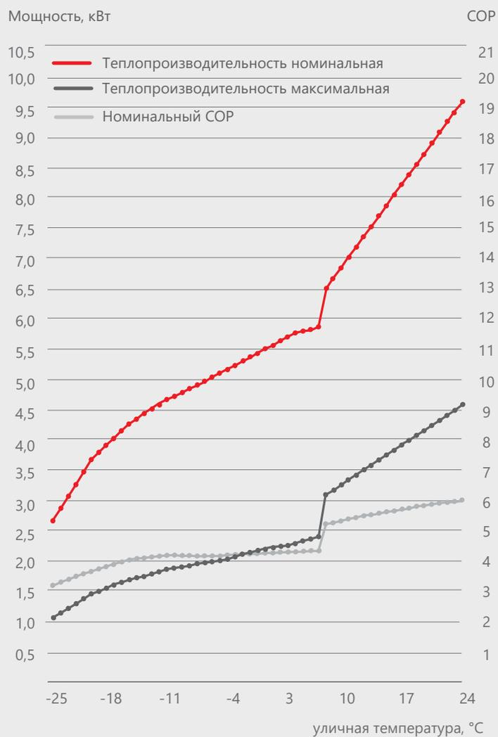
Сравнение теплопроизводительности 25 модели в зависимости от уличной температуры
