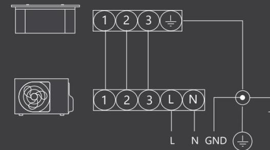
Электрическая схема (трехфазная)
