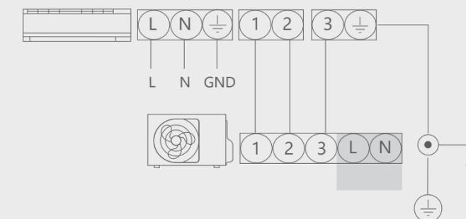
Электрическая схема (опциональная)
