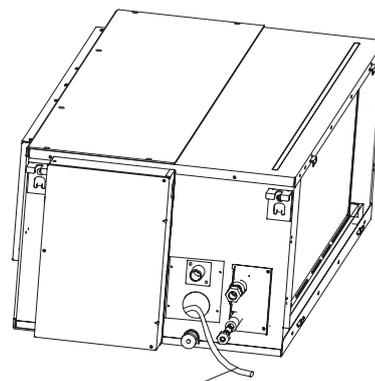
Трубка для заливания воды
