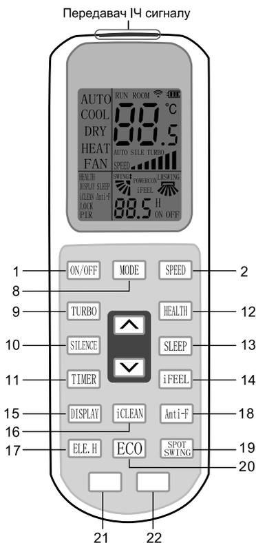
сну кондиціонер кожну годину збільшує (при режимі охолодження) або зменшує (при режимі обігріву) задану температуру на 1 °C. Через 2 години температура приймає нове значення, яке підтримується постійно протягом наступних 5 годин. Після цього кондиціонер відключається.
