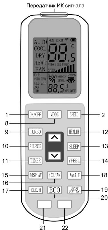
заданную температуру на 1 °C. Через 2 часа температура принимает новое значение, которое поддерживается постоянным в течении следующих 5 часов. После этого кондиционер отключается.
