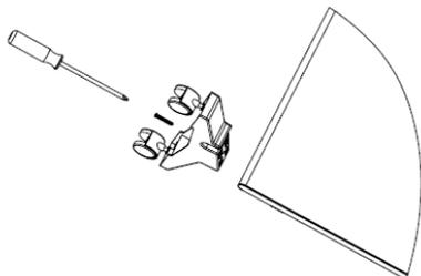
**Рис.1** Установка/снятие шасси
