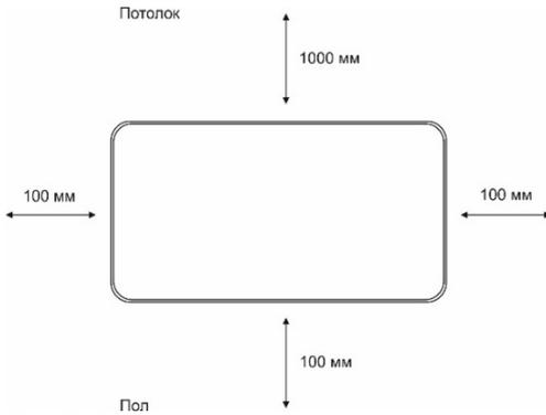
**Рис.3** Минимальное расстояние до посторонних предметов при настенной установке
