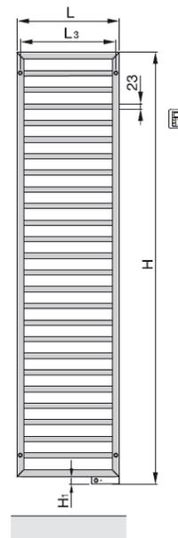
$$\begin{aligned}L_3 &= L - 30 \text{ мм} \\H &= \text{Высота} \\H_1 &= 30 \text{ мм} \\L &= \text{Длина}\end{aligned}$$
