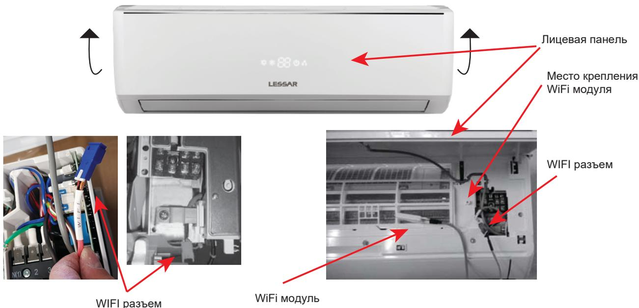
После установки Wi-Fi модуля закройте крышку электрических подключений и лицевую панель затем подайте питание на кондиционер.
