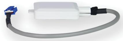
Для установки модуля Wi-Fi необходимо отключить электропитание внутреннего блока. Затем следует открыть лицевую панель и крышку электрических подключений в правой части блока, после чего — соединить разъемы модуля и внутреннего блока, (разъем Wi-Fi располагается под клеммной колодкой межблочного подключения) и закрепить Wi-Fi модуль винтом крепления.
