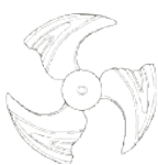
Лопasti с высоким статическим давлением
